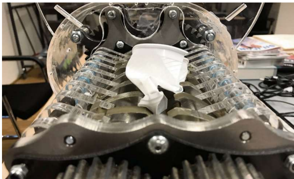
Mit einem Shredder wird Plastik wie dieser Becher zerkleinert, bevor (noch) eine Extrusion stattfindet, um aus dem Material ein Filament zu machen. Fotos Rodolfo Baiz, Isabella Finzi
